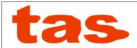
Defecto producido por una tinta demasiado líquida
