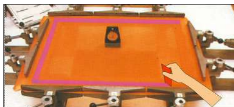
Imagen 169_01 Aplicando adhesivo al marco y la malla
