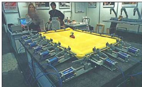
Imagen 167_01 Malla serigráfica con tensado neumático
