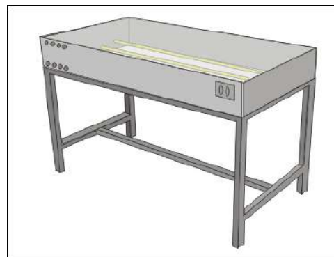
Imagen 226_01 Mesa de luz utilizada sólo para el retoque de matrices
