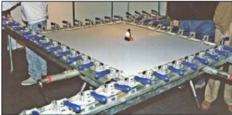
Imagen 165_01 Dispositivo para el tensado mecánico de la malla serigráfica
