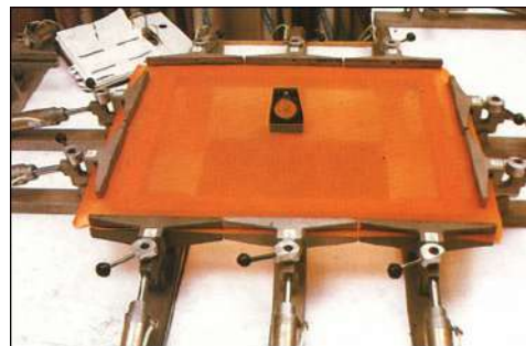
Imagen 166_01 gentileza www.gms.cl Tensimetro para mallas de serigrafía
