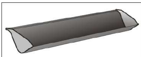
Imagen 216_01 Canoa metálica para emulsionado de la malla
