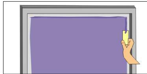
Imagen 203_04 Retirando exceso de emulsión con un trozo de cartón
