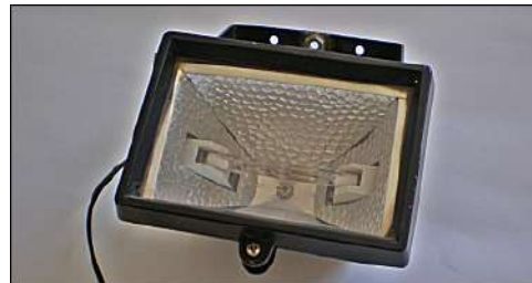
Foco halógeno de 150 watts utilizado para el fotograbado de matrices pequeñas
